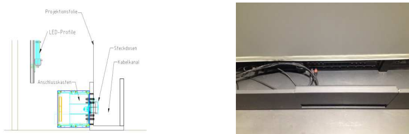
Bodenkanal mit Steckdosen und Armaturen für Verkabelungen zur Spielfläche
